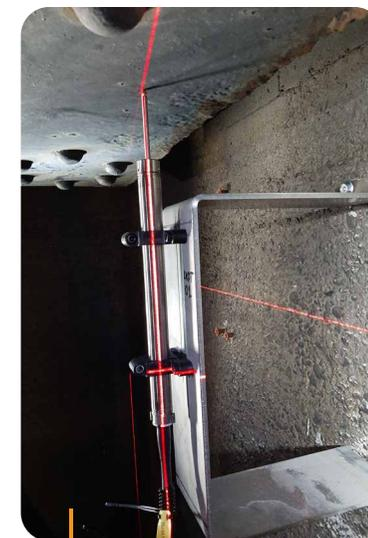
Capteur de déplacement monté verticalement.
